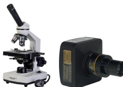
Фото 4. Микроскоп Микромед С-1 (увеличение 40-400х) цифровая камера Tourtek
